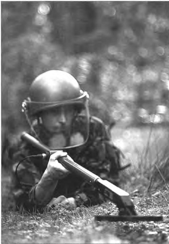
Miinat, jotka sisältävät riittävästi metallia, voidaan tunnistaa sähköisin menetelmin. Lisäksi monien konfliktien jälkeen jokaista löydettyä miinaa kohden tunnistetaan satoja paloja metalliroskaa. Jokaista metallipalaa on kohdeltava toimivana miinana, kunnes se on tunnistettu. © Military Picture Library, kuva P. Russell
