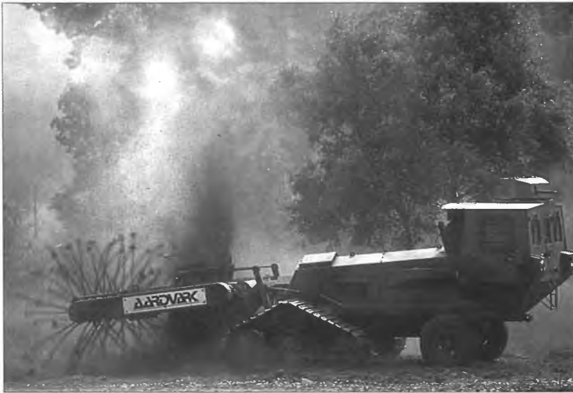
Armeijan miinanraivain voi käyttää varstoja avaamaan tien eteneville joukoille. Niiden raivausaste ei kuitenkaan ole riittävä humanitaarisille raivausoperaatioille, joiden pitää saavuttaa 99,6%:n raivausaste. © Military Picture Library, kuva R. Adshed
